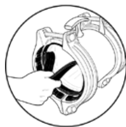
Ta ur det inre tätningsslagret för större rör YD
